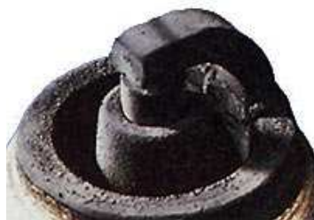
Mistura ainda muito pobre. Eletrodo seco, porém carbonizando.
