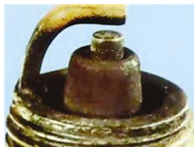
Mistura ideal. Vela seca e com cor de “café com leite”.
