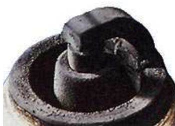
Mistura ainda muito pobre. Eletrodo seco, porém carbonizando
